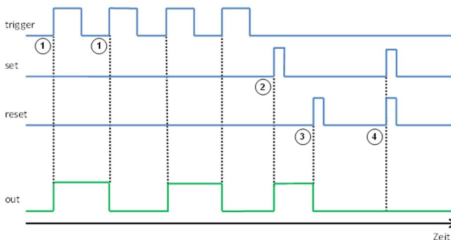
1. Jede steigende Flanke des Eingangs `trigger` ändert den boolschen Wert des Ausgangs `out`.
