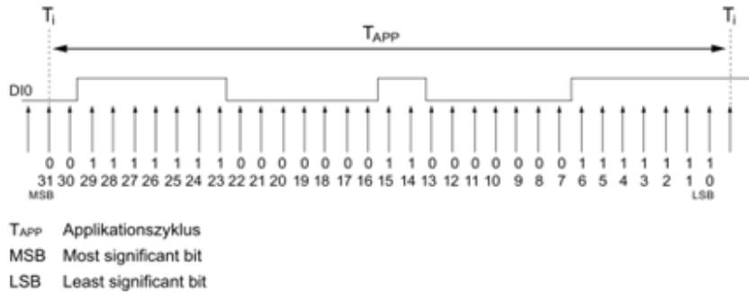
Der Baustein LGF\_CountRisInDWordFB wird in diesem Fall verwendet, um zu zählen, wie oft eine steigende Flanke vorkommt.
